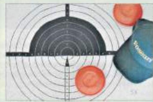
▲ Stesse condizioni sperimentali, ma distanza di tiro aumentata a 30 metri, con la seconda canna (stozzatura Full); non c'è di che lamentarsi del risultato balistico ottenuto.
