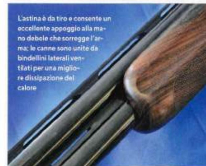
L'astina è da tiro e consente un eccellente appoggio alla mano debole che sorregge l'arma: le canne sono unite da bindellini laterali ventilati per una migliore dissipazione del calore
